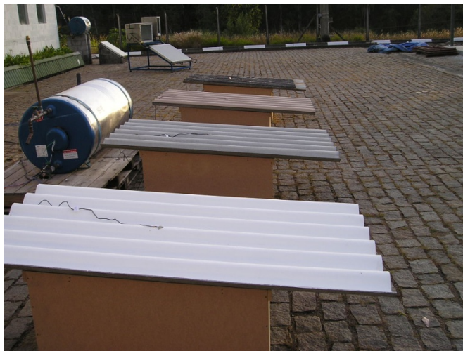
Foto 1 – Telhas de fibrocimento instaladas com sensores que registram temperaturas
